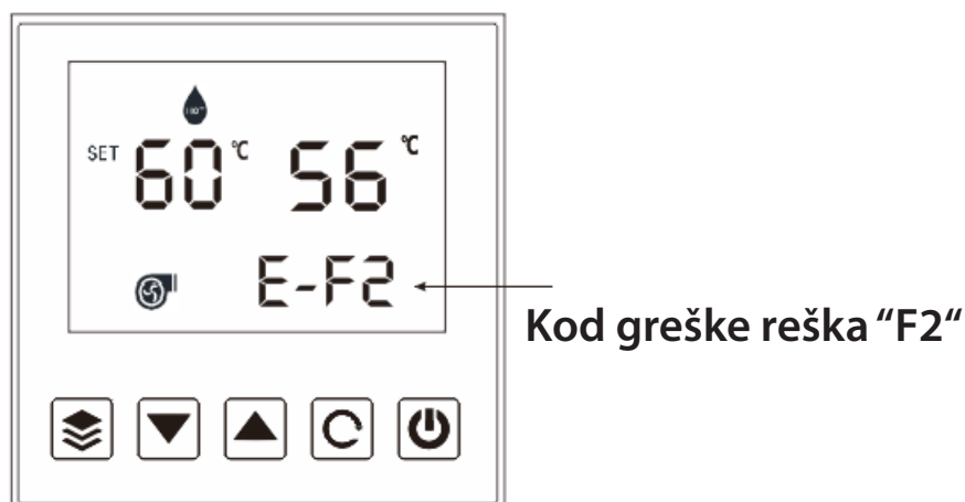
Slika 18. Na displeju je ispisna greška "F2"
